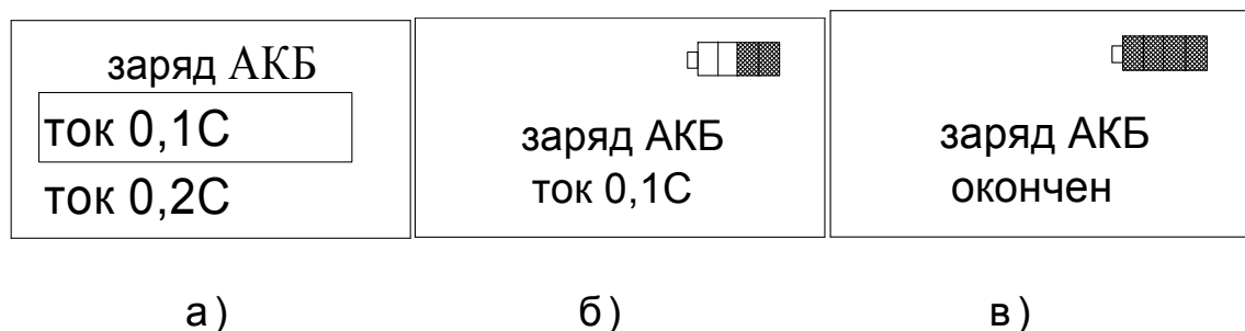
Рисунок 3.1 – Сообщения на табло при заряде АБ
